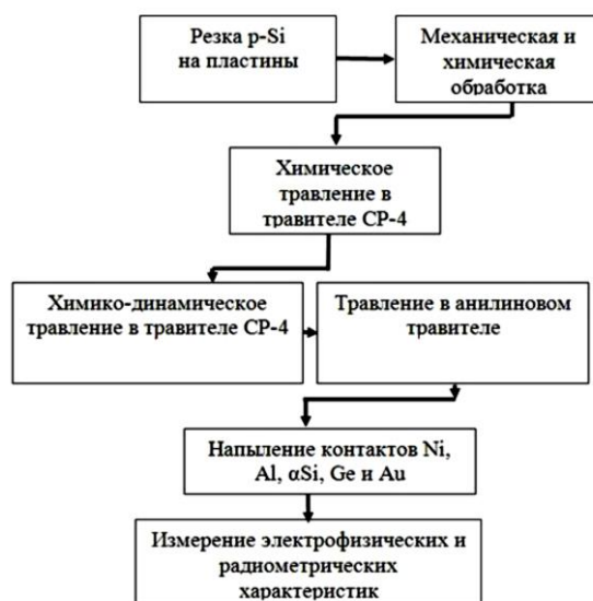
Рис.1. Технологическая маршрутная карта изготовления детекторов.
