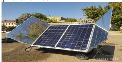
4-rasm. FIB asosidagi mobil suv chiqaruvchi qurilmaning sinov jarayonida olingan tasviri.
