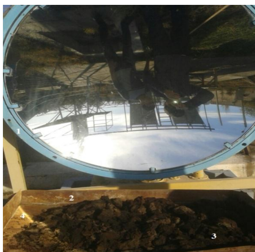
Рис. Опытная установка для обработки обезвоженной осадки
