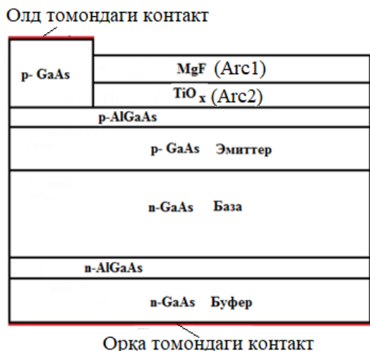
1-расм. Юпқа қатламли GaAs қуёш элементини тузилиши
