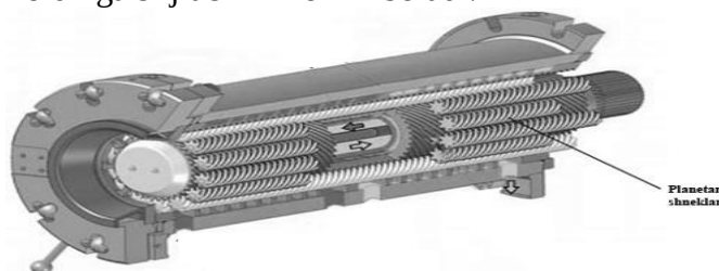
2-rasm. PRE150- markali planetar-valikli ekstruderning kesimi
