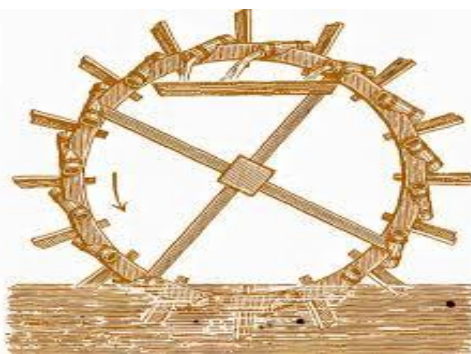
Chig‘ir konstruksiyasining ko‘rinishi.
