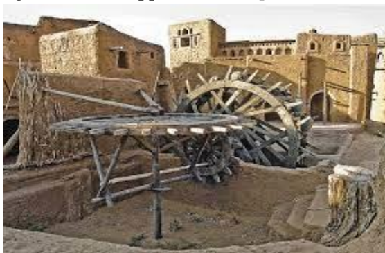
Inson qo'l kuchi bilan ishlaydigan chig'ir.
