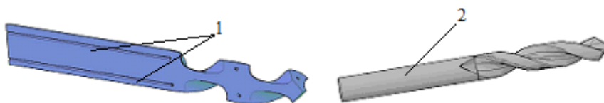
6-расм. Қаттиқ қотишмали металл кукунидан тайёрланган парма: 1-мойловчи-совитувчи суюқлик оқувчи қувурлар; 2-жилвирланган тайёр парма.
