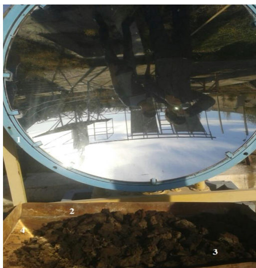
Рис. Процесс пастеризации осадок сточных вод кокономотального производства 1-солнечный концентратор, 2- приспособления из железного листа, 3- осадки.
