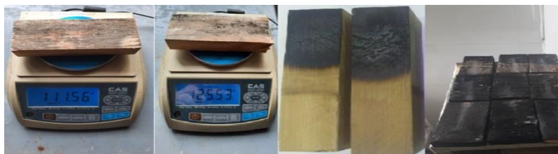
3-rasm. Antipirenlar bilan ishlov berilgan yog'och namunalari
