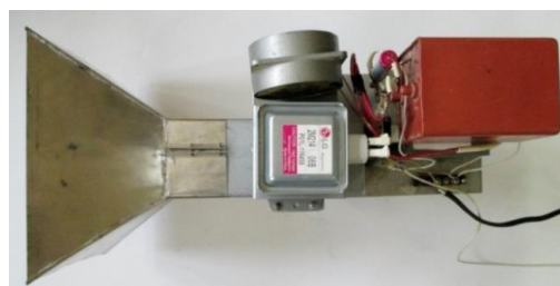
Рисунок 5. Схема устройства для СВЧ-плазменной обработки образцов и СВЧ лампа:
