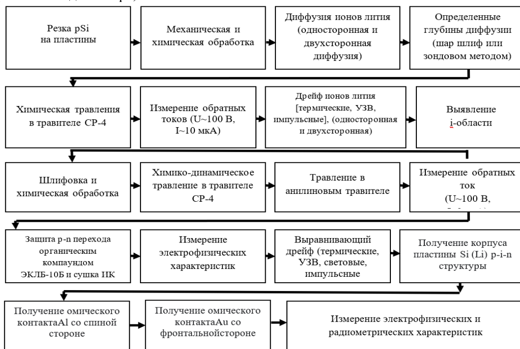
Рис. 2. Технологическая маршрутная карта изготовления Si (Li) детекторов для разработки портативного дозиметра.
