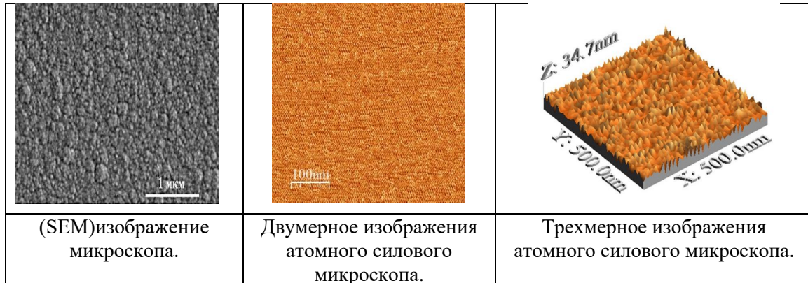
Рис. 4. Морфология Mn_4Si_7 (СЭМ) и (АСМ).
