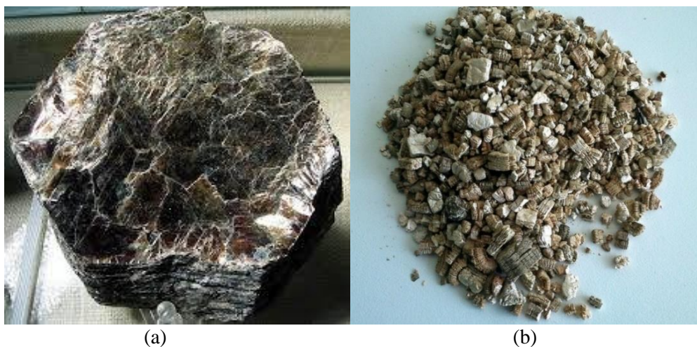
2-rasm. Tebinbuloq koni vermikulitining tabiiy(a) va g‘ovaklashtirilgan(b) holatdagi ko‘rinishi
