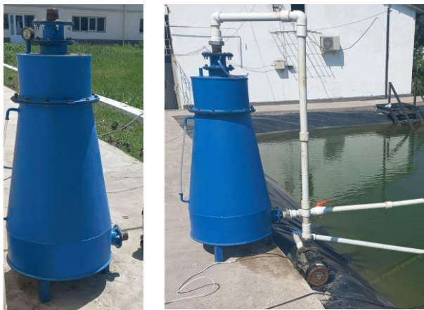
1-rasm. Kislorod konusi(oksigenator) qurilmasi yoki Suvni kislorod bilan boyitish qurilmasi.
