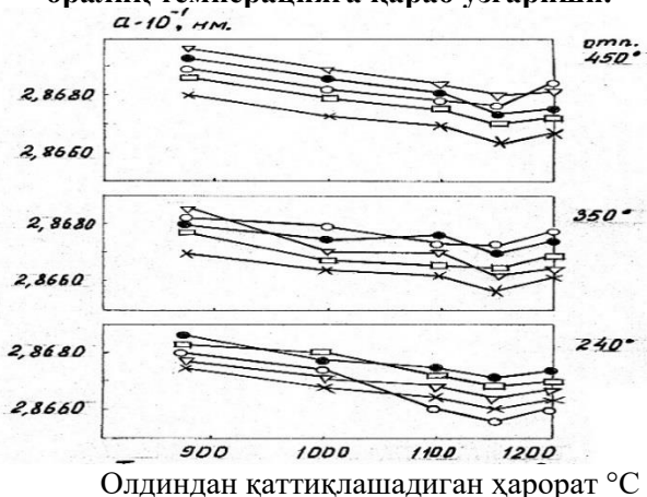
5ХНМ пўлатдан ясалган панжара даврининг дастлабки қотиш ҳароратига, оралиқ температурага қараб ўзгариши.
